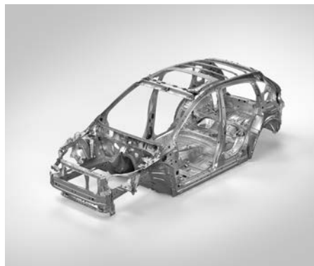
Tvirtų žiedinių rėmų kėbulo konstrukcija
